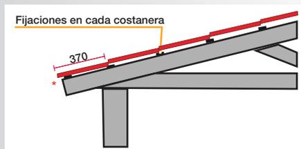
Inicie el montaje calzando la cubierta sobre las costaneras como indica la FIGURA. Fije los tornillos iniciales sobre la 1ra costanera en todos los valles. Las fijaciones sucesivas se realizan en cada costanera.
